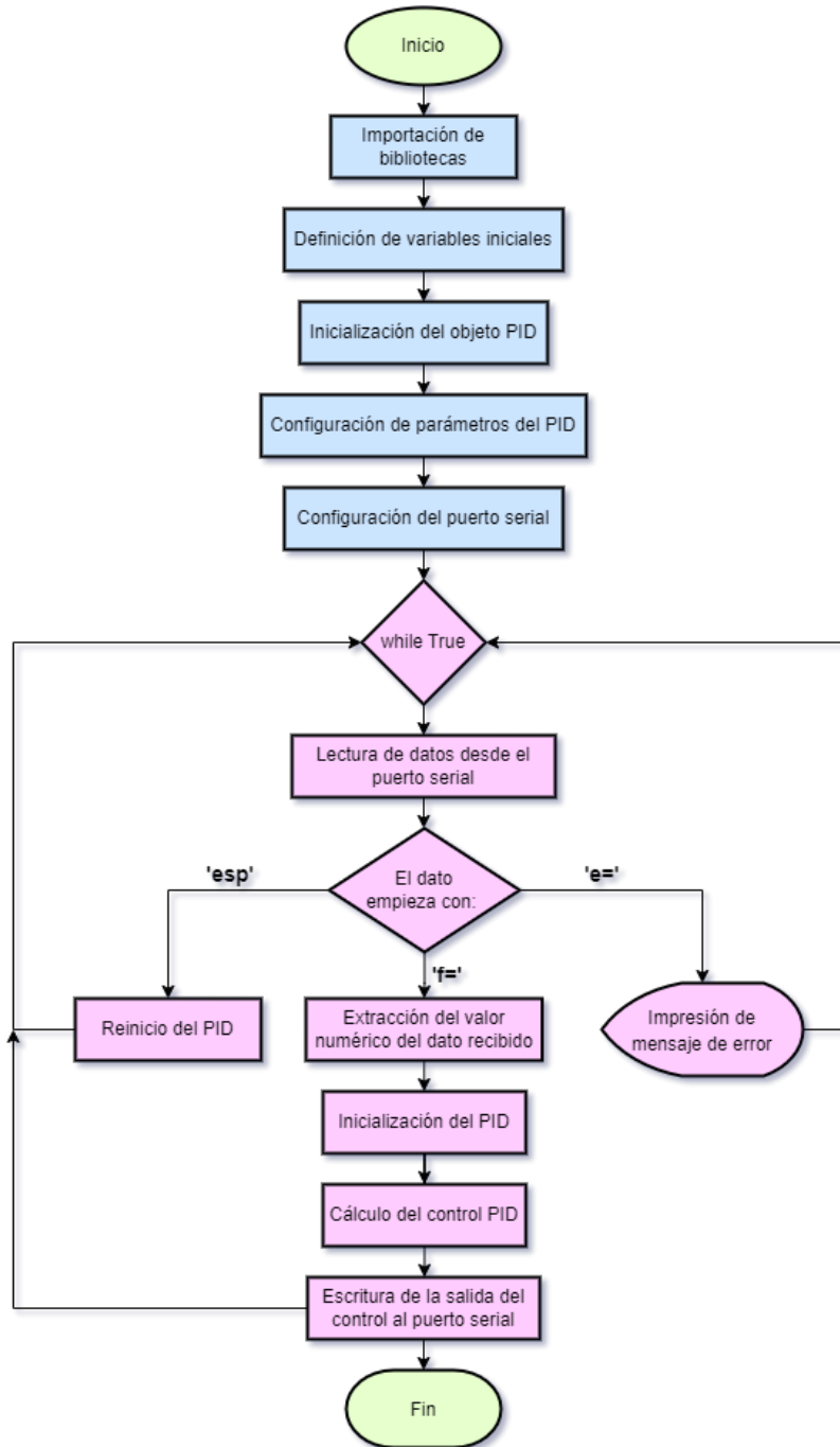
Figura 12. Diagrama de flujo del código principal del control PID en Python
