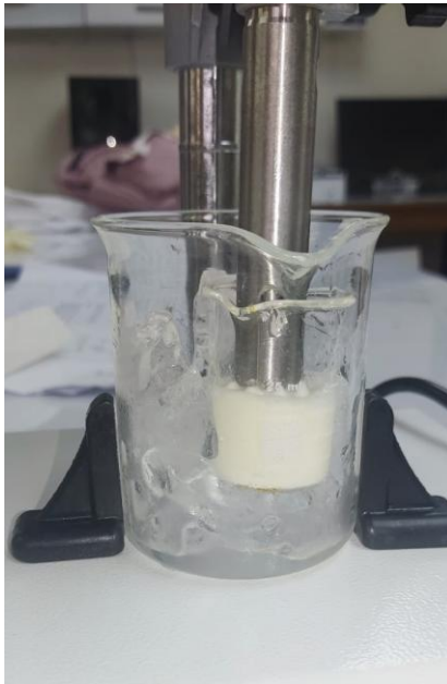
Fig. 5 Nanoemulsión realizada en un homogenizador Ultra Turrax. Fuente: propia.
