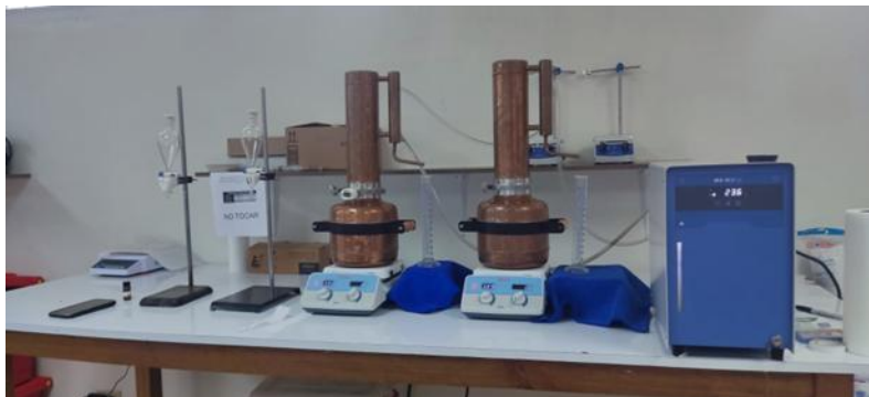
Fig. 3 Sistema de destilación por arrastre de vapor Fuente: propia
