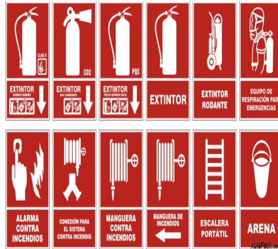
Figura No. 2. Señales de equipo contra incendios.
