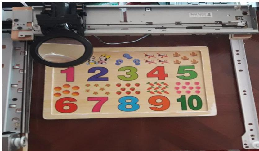
La lupa simple, o amplificador de vidrio, está constituida por una única lente convergente. Como el nombre implica, este dispositivo aumenta el tamaño aparente de un objeto.
