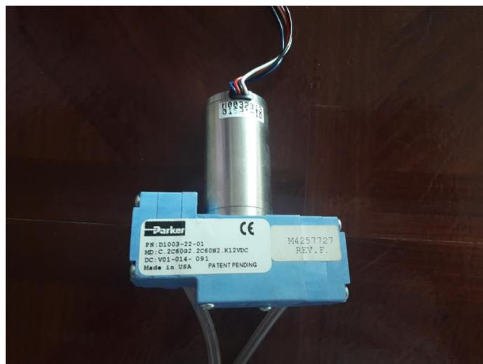
Este tipo de bomba de succión o bomba al vacío se utiliza para extraer cualquier fluido de un medio a otro, por lo tanto, el uso de la bomba de succión en mi prototipo es tomar las páginas de un libro a través del controlador de velocidad de succión (Parker, 2015).
