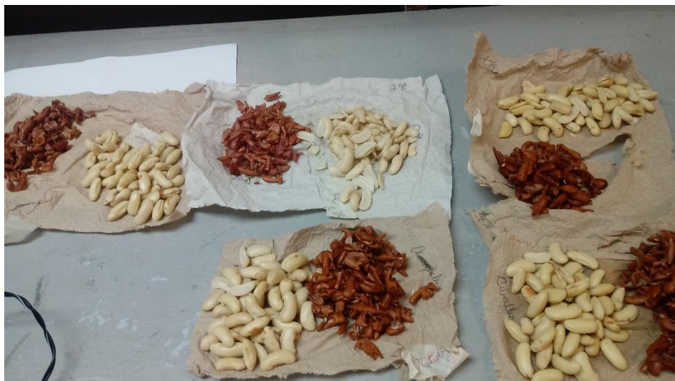
Imagen N°8 Proceso de trabajo para realizar las pruebas de porcentaje de cáscara
