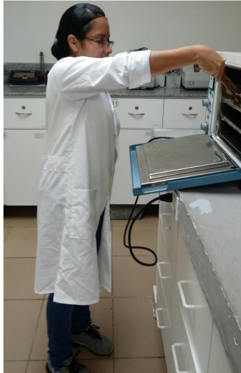
Imagen N°5 Prueba de humedad
