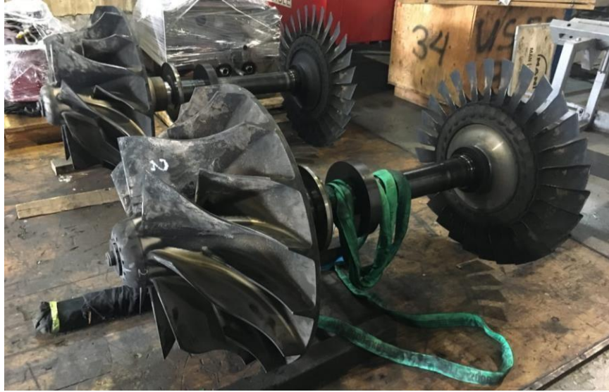
Imagen 3. Muestra de las condiciones de suciedad en las cuales son recibidos los componentes en el taller (Rotor de Turbo Cargador).
