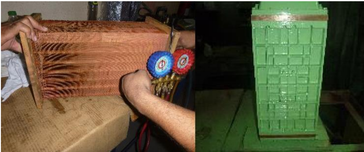
Imagen 6. Muestra de las condiciones de suciedad en las cuales son recibidos los componentes en el taller (Enfriador de Aire).
