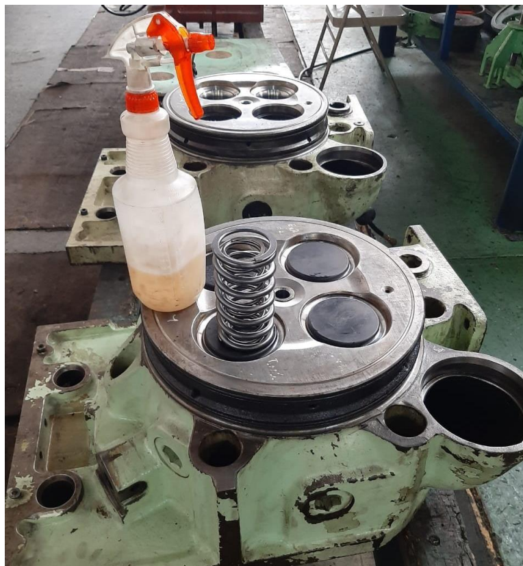
Imagen 8. Utilización de desengrasante en aspersor manual lo que facilita su inhalación al momento de la aplicación.
