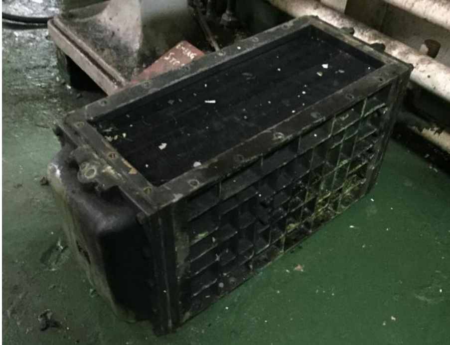
Imagen 5. Muestra de las condiciones de suciedad en las cuales son recibidos los componentes en el taller (Enfriador de Aire).
